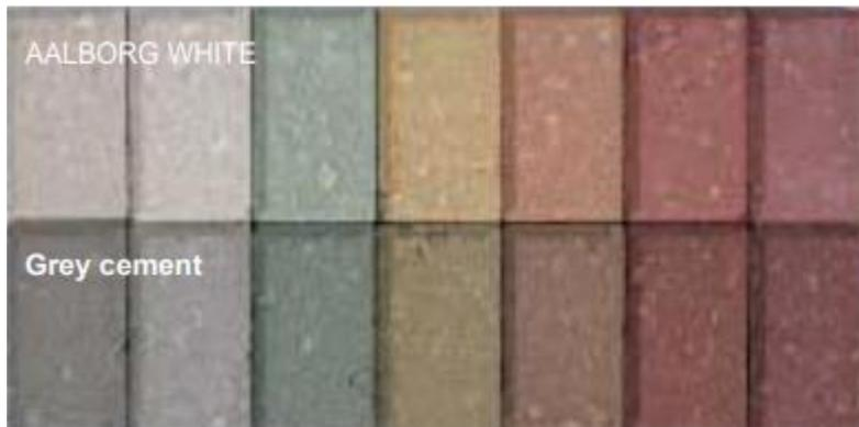
利用阿尔博白水泥的高纯度和稳定性，GRC 制造商可以生产出高性能和颜色稳定的构件成品。白水泥的高纯度和质量稳定，是生产高品质彩色产品的关键——即使是灰色水泥基建筑产品，也常常以白色水
